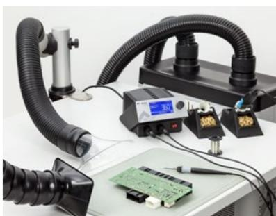
La alta flexibilidad de los extractores de humos **EASY ARM 1** e **EASY ARM 2** son basados en 15 años de experiencia en el campo de procesos de limpieza de aire. Su funcional diseño y la combinación de su rango alto de extracción con un eficiente sistema de filtrado y la silenciosa operación, caracteriza a ambos sistemas. La variedad de brazos de extracción, permite la fácil adaptación para cualquier área de trabajo
