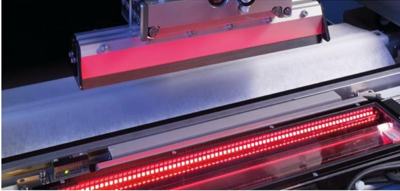
Con su totalmente integrada, AOI de cobertura total, instalada después del paso de impresión, en la gama de modelos **VERSA-PRINT P1** y **VERSA-PRINT S1** ofrecen muchos avances a los usuarios.
